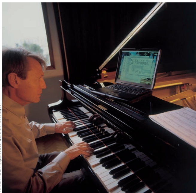
Jean-Claude Risset au piano Disklavier. Chaque touche est munie d'un capteur et d'un moteur.
